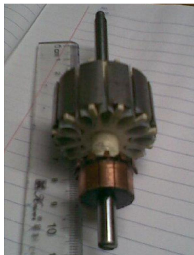
Hình 4: Hình ảnh lõi thép, cổ góp của phần ứng máy xay
